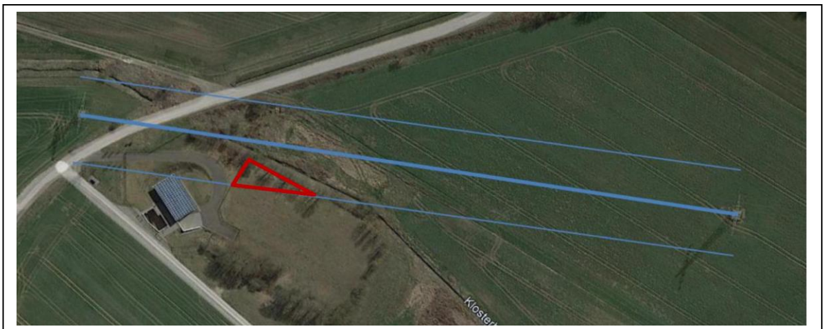
Abb.7: Leitungsführung Hochspannungsfreileitung mit Schutzstreifen – rot = Überschneidung Plangebiet (Ing.-Ges. Tutas Meyer – unmaßstäblich)
